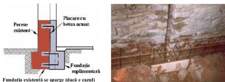
Fig.5. Consolidare fundație continuă existentă sub ziduri
