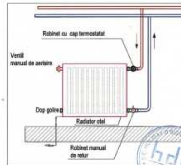
Schema racordare radiator pe o parte Radiator ≤1000 mm - SC. : %
