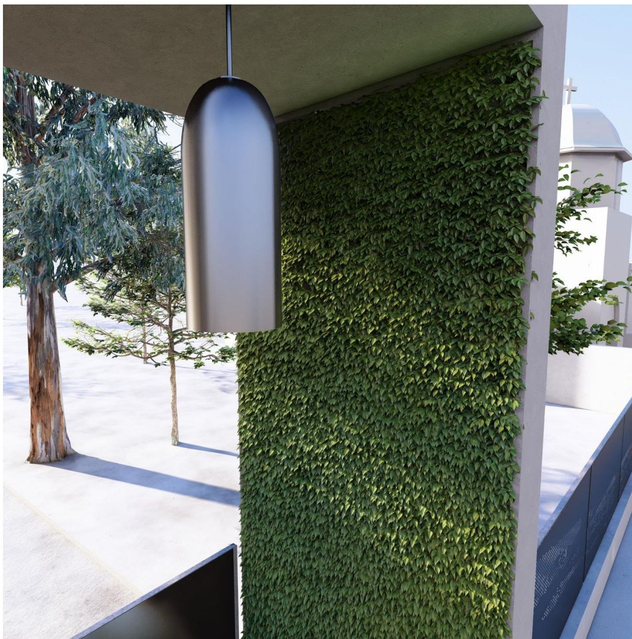
Poarta P01 – Detaliu de perete verde montat vertical pe fața interioară a portalului din beton.
