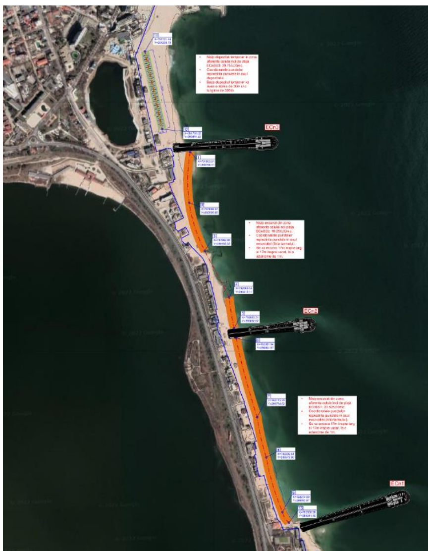
Vedere generala: substrat nisip pentru populatia de Donacilla si Donax. excavatii si depozit temporar (extras 223.46-VO-INT-ENG-DWG-9004)
