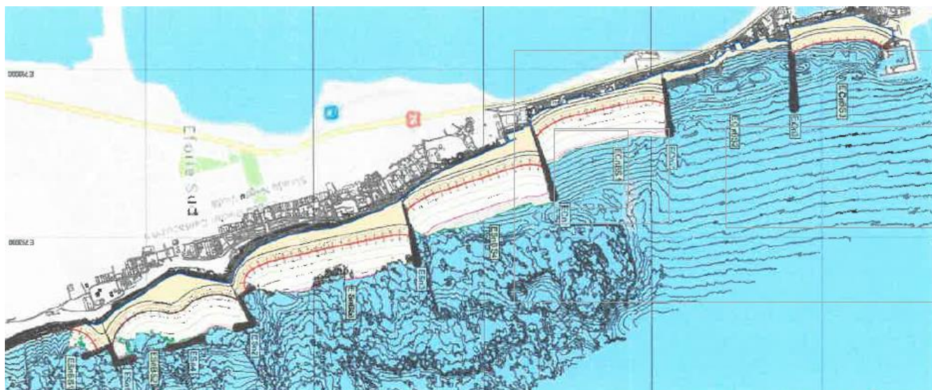
Vedere de ansamblu a structurilor costiere si zonelor de innisipare conform acordului de mediu actualizat
