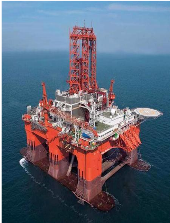
Figura 7 – Reprezentare Instalatie Mobila Offshore de Foraj
