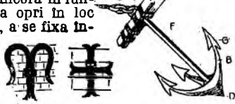
Fig. 120. Ancoră. L. Limbă.—I. Inel. —T. Traversă. —F. Fus.—G. Ghiară. —B. Braț.—D. Dia- mant.
