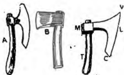
Fig. 374. Barde. A. Bardă de dulgher. — B. Bardă de rotar. — M. Muchie. — V. Virf. — L. Leașă. — C. Calciu. — T. Toporiște sau coadă.
