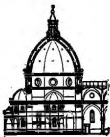
Fig. 1869. Domul din Florența (Secțiune).
