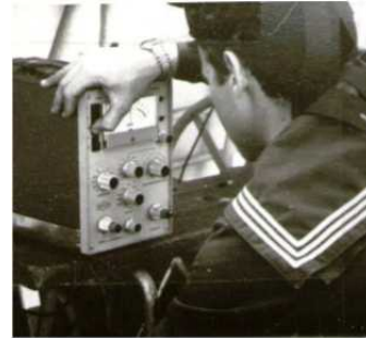
Fig. 21.8. Calibrarea tensometrului IEMI N2301
