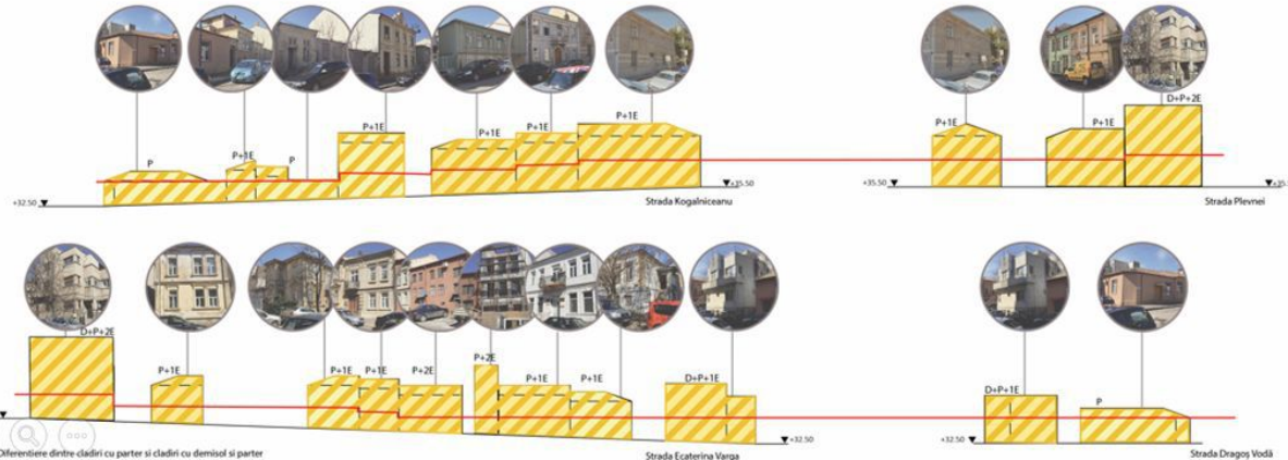
Diferentiere dintre cladiri cu parter si cladiri cu demisol si parter
