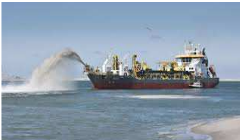
Fig. 3 – Pompare la tarm prin metoda rainbow (www.boskalis.com)
