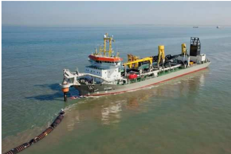
Fig. 4 – Pompare la tarm prin conductă (www.boskalis.com)
