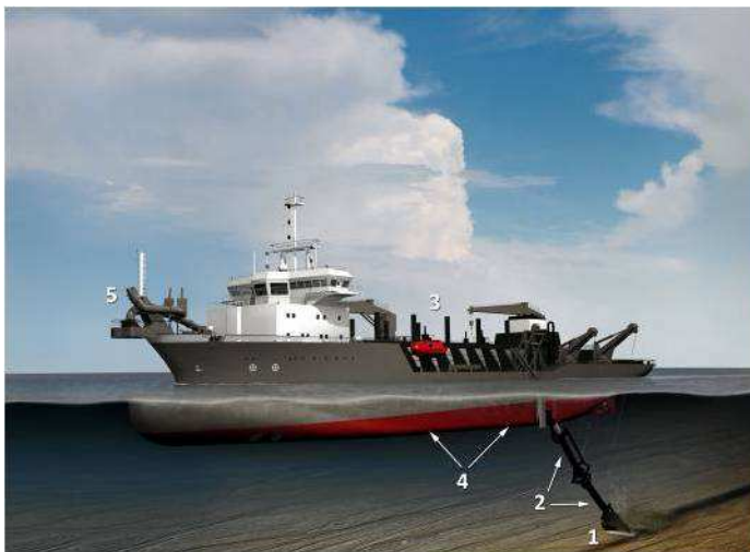
Fig. 2 – Operatiunea de incarcare a unei dragi TSHD (www.boskalis.com)
