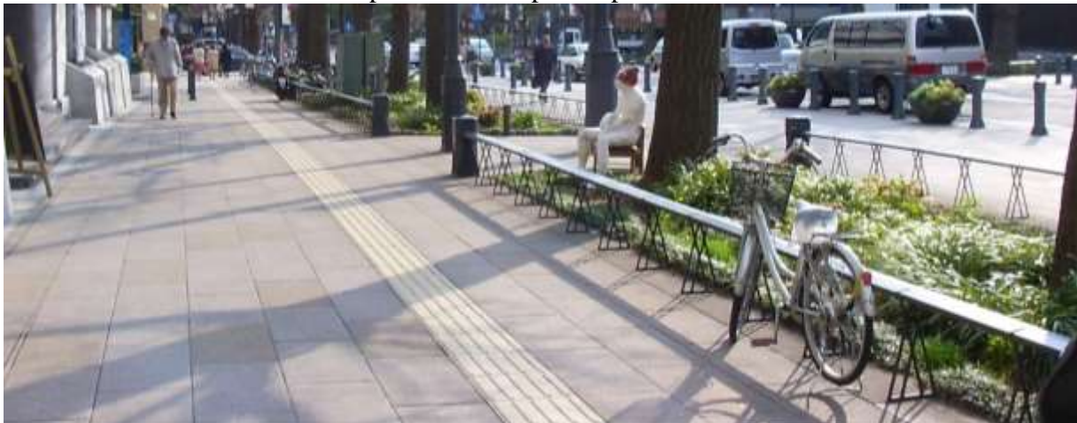
Foto: Trotuar accesibilizat cu suprafata tactila pentru persoane fara vedere
