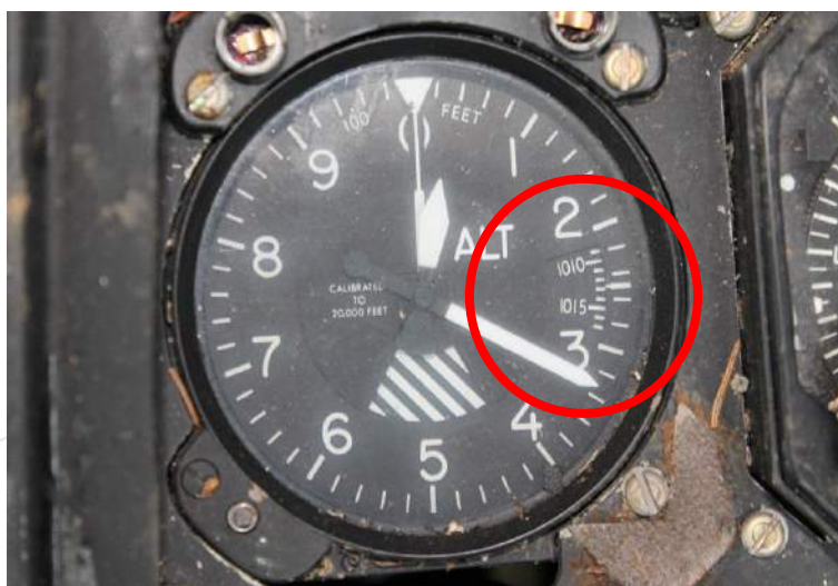
Figura 75 Altimetrul nr. 2 (setare 760 mmHg = 1013 mb)
