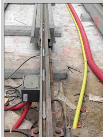
Figura 6: detalierea sistemului de aplicare a lubrifianului
