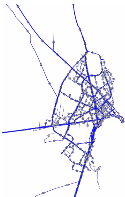
Figura 16: Fluxurilor de trafic simulate in scenariul 2015 mediu. Autoturisme. “Studiu General de Circulație-2007”
